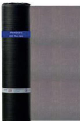
MEMBRANA JD2 PLUS ARE es fabricada con asfaltos seleccionados modificados, con una combinación de elastómeros de SBS y aditivos especializados que le otorgan de una elevada resistencia al calor, alta adhesividad y flexibilidad en frío de al menos  $-10^{\circ}\text{C}$ . Su espesor es de 3mm. Posee un refuerzo central de poliéster no tejido químicamente estabilizado de gramaje  $\geq 180 \text{ gr/m}^2$  que provee de una elevada resistencia mecánica y dimensional.
