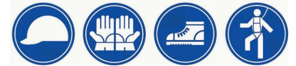
Ilustración 106. Elementos de protección personal básicos para trabajos en techumbre
