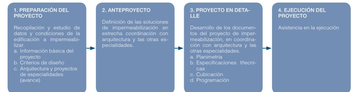
Ilustración 101. Etapas de la elaboración del proyecto de impermeabilización
