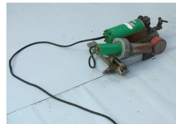
**Ilustración 109.** Máquina de termosoldado.
