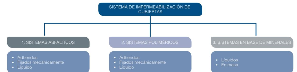
Ilustración 104. Categorías de sistemas de impermeabilización según tipo de fijación
