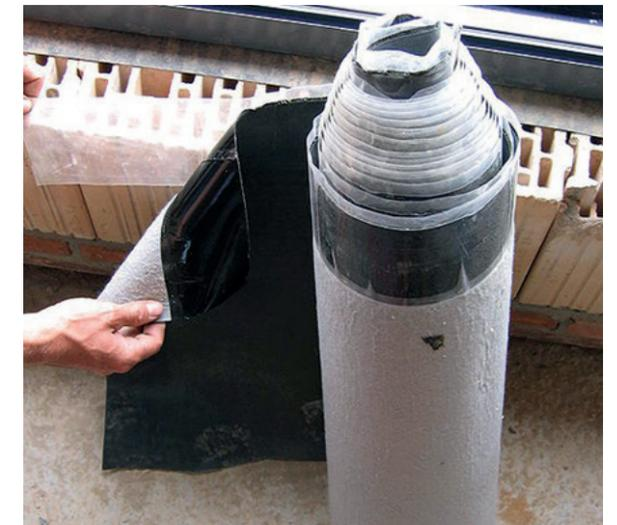
Ilustración 114. Rollo de membrana EPDM.
