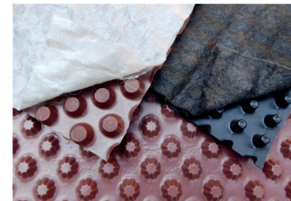
Ilustración 39. Láminas drenantes con geotextil adherido (arriba) y sin geotextil.
