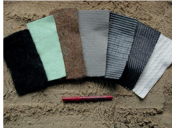
**Ilustración 36.** Diferentes tipos de geotextiles.
