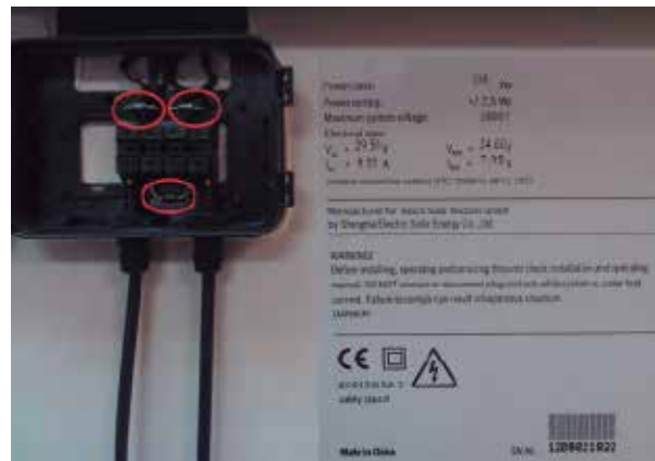
FIGURA 1.24 Vista posterior de un módulo fotovoltaico. Se observan los diodos de bypass (en círculos rojos), la caja de conexión y los principales parámetros eléctricos del módulo, para el modelo c-Si M 48 de Bosch.
