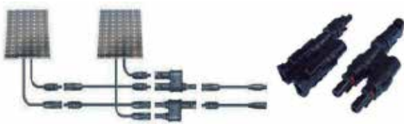
FIGURA 2.8 Conexión de módulos en paralelo. Se aprecia en detalle el conector paralelo MC4. Fuente: Natural Tech.
