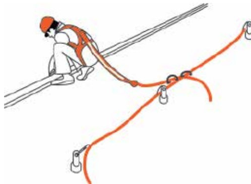
FIGURA 3.1 Trabajo en altura. Ejemplo del uso de arnés y cuerda de vida. Fuente: "Sistemas Solares Térmicos II", CDT, PNUD, Procobre.
