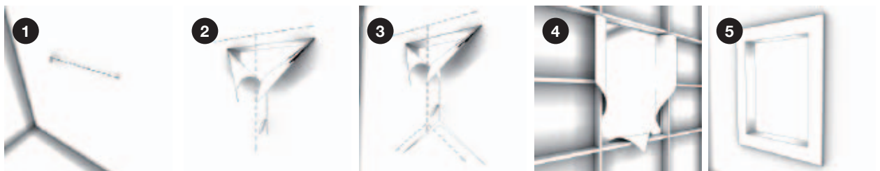
Figura 5.27. Procedimiento de instalación de ventanas y puertas después de aplicada barrera de humedad.
