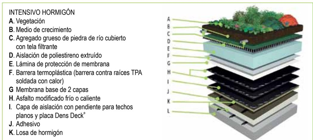
Imagen 6.1 Ejemplo de cubierta vegetal Intensiva sobre hormigón. (Gentileza Tremco Roofing.)
