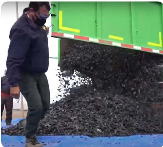
Esta empresa recicla las tuberías de HDPE en desuso, las cuales son trituradas mediante una máquina chipeadora. La materia prima obtenida se envía a la empresa Polytex, que se encarga de fabricar nuevas tuberías. Estas tuberías son adquiridas nuevamente, fomentando la economía circular a través del reciclaje y demostrando que esta metodología es aplicable al sector de la construcción.
