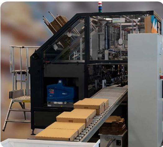
La empresa Sealed Air trabaja bajo un sistema automatizado y tecnologías digitales para la fabricación de embalajes que permite reducir el material a utilizar y minimizar los costes operativos. El sistema mide la altura del contenido, puntúa y dobla el material corrugado sobrante para luego sellar la caja de manera precisa, sin perder material, optimizando los procesos productivos y reduciendo la generación de residuos
