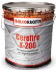
Revestimiento intumescente base solvente, desarrollado para la protección del acero expuesto directo al fuego, retardando el colapso de las estructuras. El Cerefire X-200 protege para factores desde F-15 hasta F-90, dependiendo de la masividad de la estructura.
