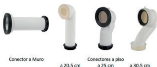
Sistema de descarga de bajo consumo de 4,1 L para desechos líquidos y 6 L para desechos sólidos. Su funcionamiento es por acción directa con efecto de arrastre y anillo cerrado en versiones al piso a 20.5 y 25 cm o al muro. Acción directa con efecto de sifón, trampa reversa y anillo cerrado en versión al piso a 30.5 cm. Modelo debe instalarse con conector a muro o a piso según necesidad.
