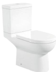
El modelo Cádiz es un inodoro de 2 piezas, de modelo europeo, de trampa tapada y líneas estilizadas. Su asiento de polipropileno de alta resistencia tiene cierre suave lo que permite alargar su vida útil. Fabricado con sistema Dual Flush de doble descarga que lo posiciona como un producto con ahorro de agua. Modelo multidescarga que puede instalarse a piso o a muro con distintos conectores.
