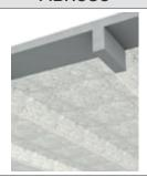
Revestimiento proyectable fibroso, fabricado en base a fibras minerales, ligantes hidráulicos inorgánicos y aditivos.
