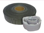
Bostik FP 340 PIPE WRAP es una cinta intumescente flexible en base a grafito, que evita la propagación del calor, el humo y el fuego en perforaciones dejadas por tuberías en muros, suelos o techos. Puede alcanzar una resistencia de hasta 4 horas al fuego.
