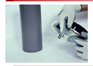
El collarín cortafuego están formado por una carcasa metálica de 0,7 mm de espesor de acero galvanizado o 0,5 mm en acero inoxida-ble a la que se adhieren láminas de grafito intu-mescente de 2,5 mm de espesor de 30 o 60 mm de ancho, en función del diámetro del collarín.
